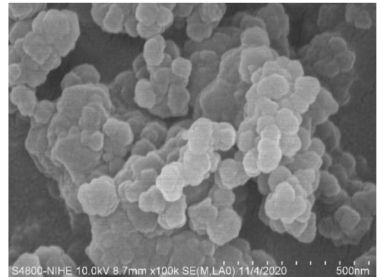
Hình 3.4: Ảnh SEM của vật liệu UiO-66- NO_2
