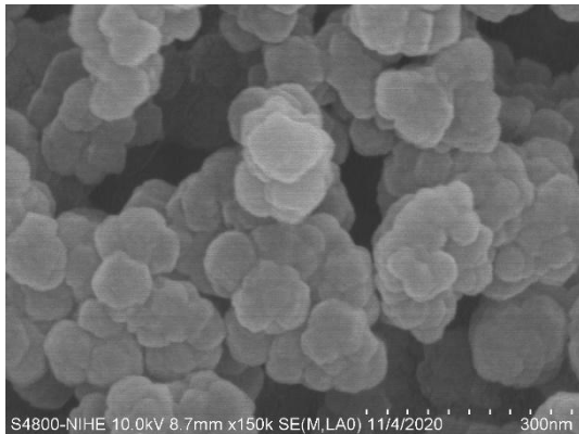
Hình 3.4: Ảnh SEM của vật liệu UiO-66- NO_2
