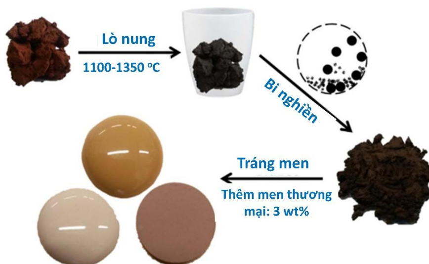
Hình 1.10. Sơ đồ quá trình chuyển hóa bùn đỏ thành chất tạo màu trong men
