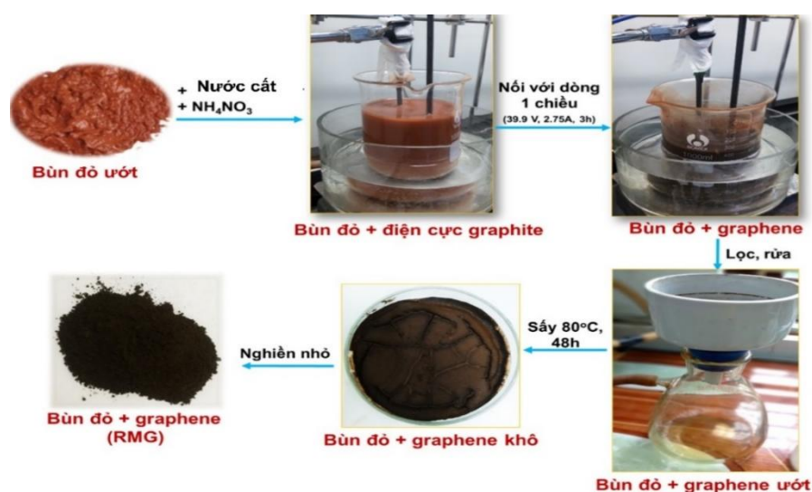
Hình 2.5. Sơ đồ chế tạo vật liệu bùn đỏ/graphene (RMG)
