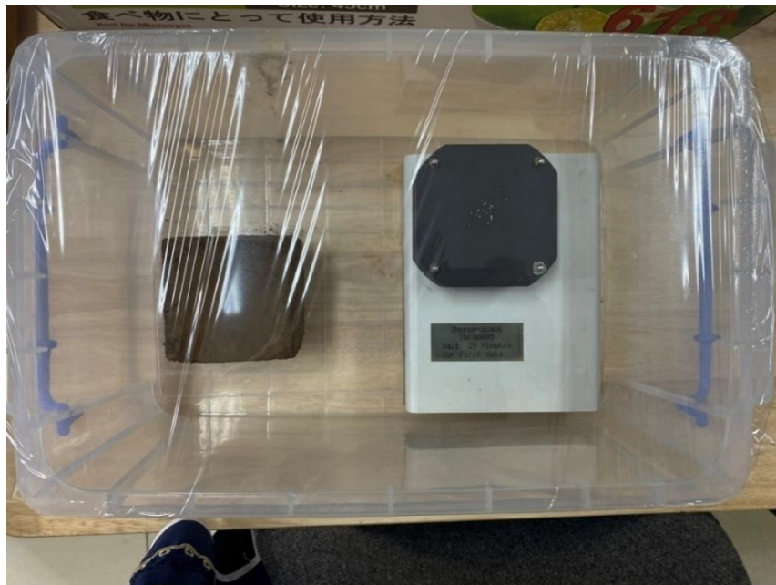
Hình 2. 10 Khảo sát nồng độ khí radon từ các mẫu gạch bằng thiết bị Thoron Scout.
