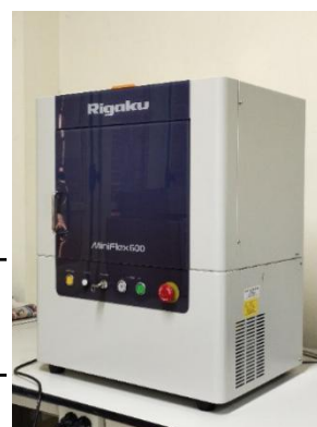
Hình 2.4. Mô tả sự phản xạ trên bề mặt tinh thể và máy XRD, model MiniFlex 600, Rigaku Corp, Nhật Bản.
