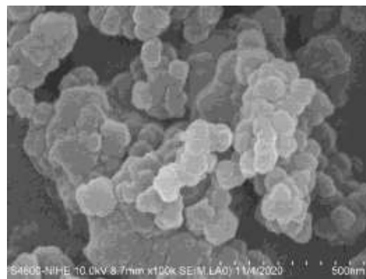
Hình 3.4: Ảnh SEM của vật liệu UiO-66- NO_2
