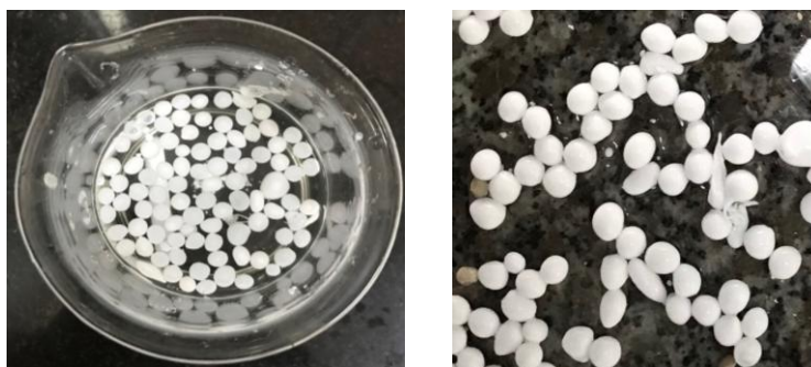
Hình 3.21. Hạt PVA/ \text{NaNO}_3 sau khi sục khí
