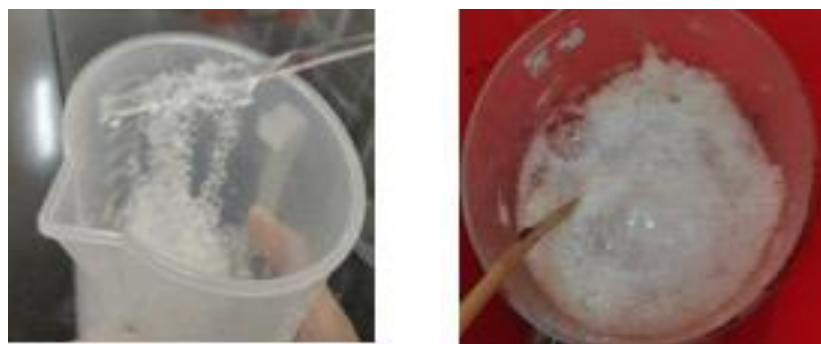
Hình 3.20. Hiện tượng hạt gel PVA/ \text{H}_3\text{BO}_3 bị vỡ sau sục khí
