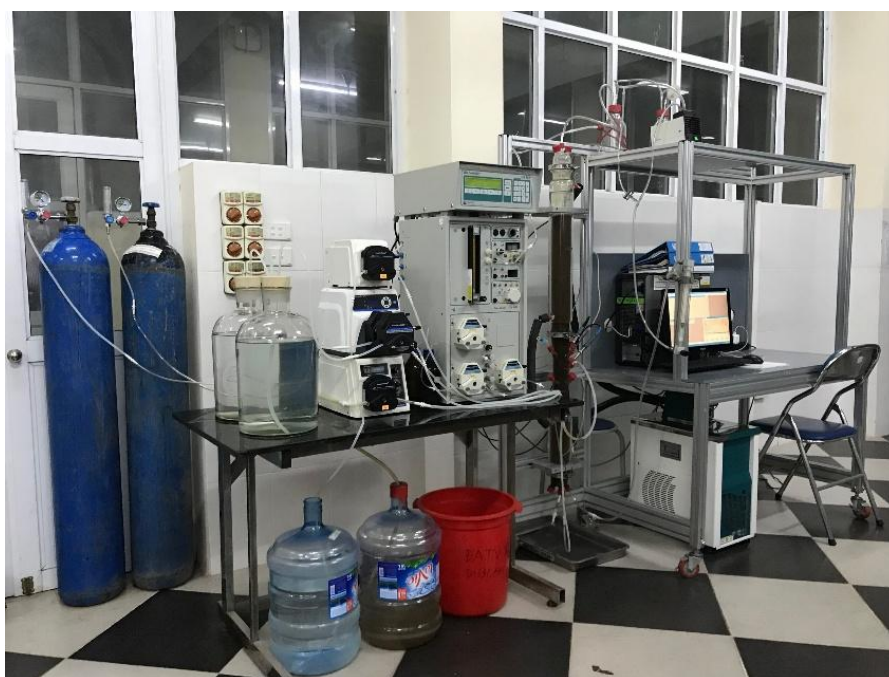
Hình 2.14. Hình ảnh thực tế hệ AGS-SBR tại phòng thí nghiệm
