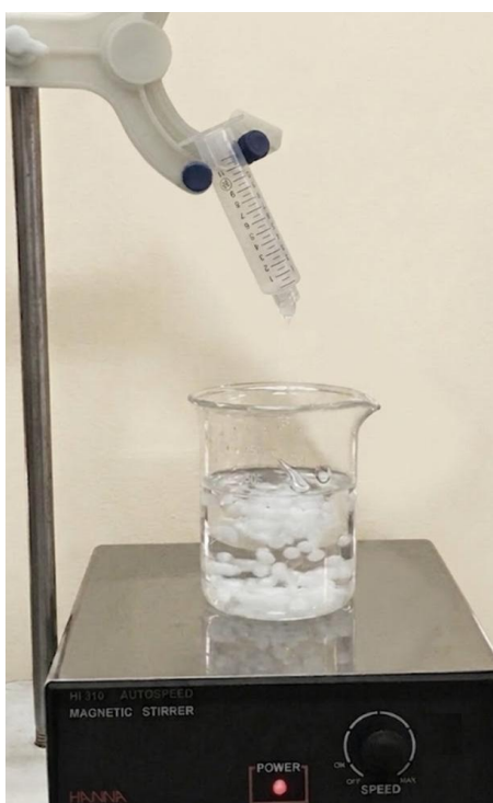
Hình 2.18. Quá trình nhỏ giọt tạo hạt PVA
