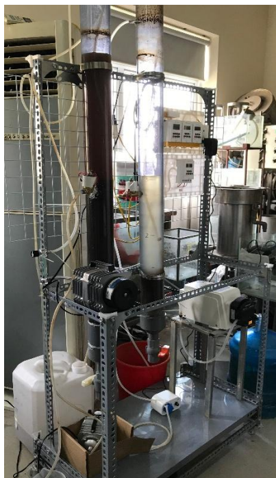
Hình 2.16. Hình ảnh thực tế hệ MB-SBR tại phòng thí nghiệm
