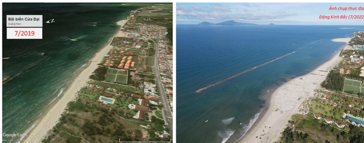
Hình 4.26. Bãi biển Cửa Đại thay đổi từ 2019 đến 2022 sau khi được gia cố kè song song với bờ và đổ cát lấn biển (Nguồn: Đặng Kinh Bắc, 2022)
