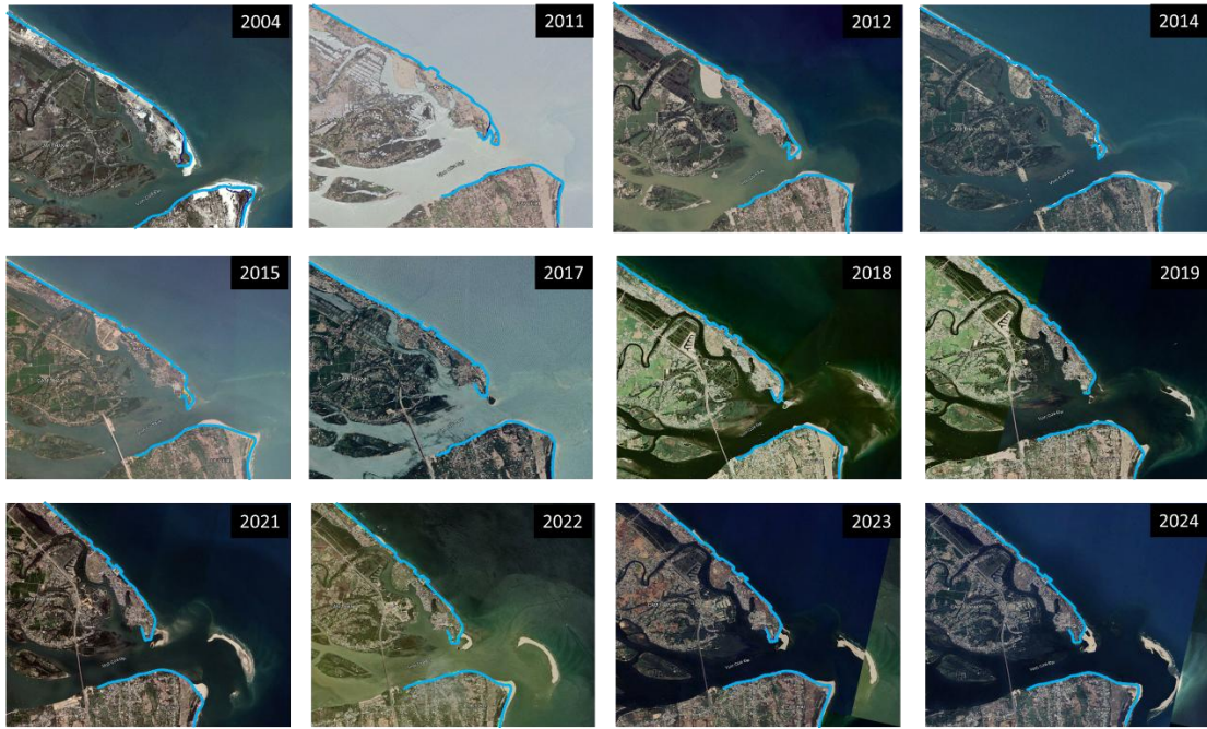
Hình 4.19. Đường bờ trong khu vực Cửa Đại, Đà Nẵng được chiết tách từ năm 2004 đến 2024 để đưa vào mô hình DSAS
