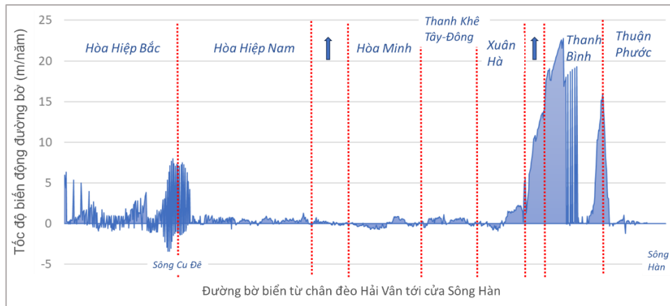
Hình 4.9. Biểu đồ biến động đường bờ trong theo phương pháp LRR (đơn vị: m/năm)
