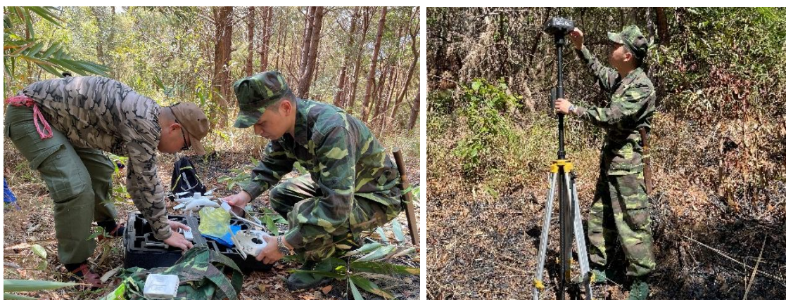
Hình 5. Sử dụng UAV và RTK thu thập dữ liệu và kiểm chứng mẫu chìa khóa ảnh tại thực địa
